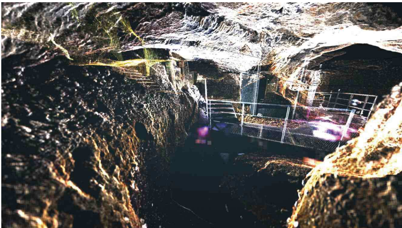
Figure 32. Vue 3D du nuage de points issu du laserscan https://bit.ly/2XTello (© archeodev.ch)
