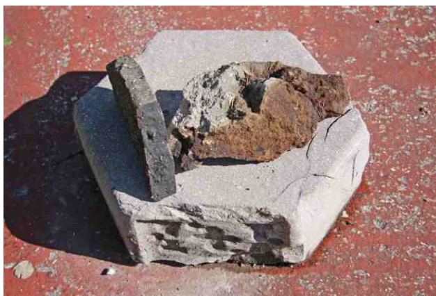
En brun, le minerai d'asphalte, en gris le pain hexagonal prêt pour l'expédition et en noir de l'asphalte coulé pour recouvrir un trottoir (mg)
