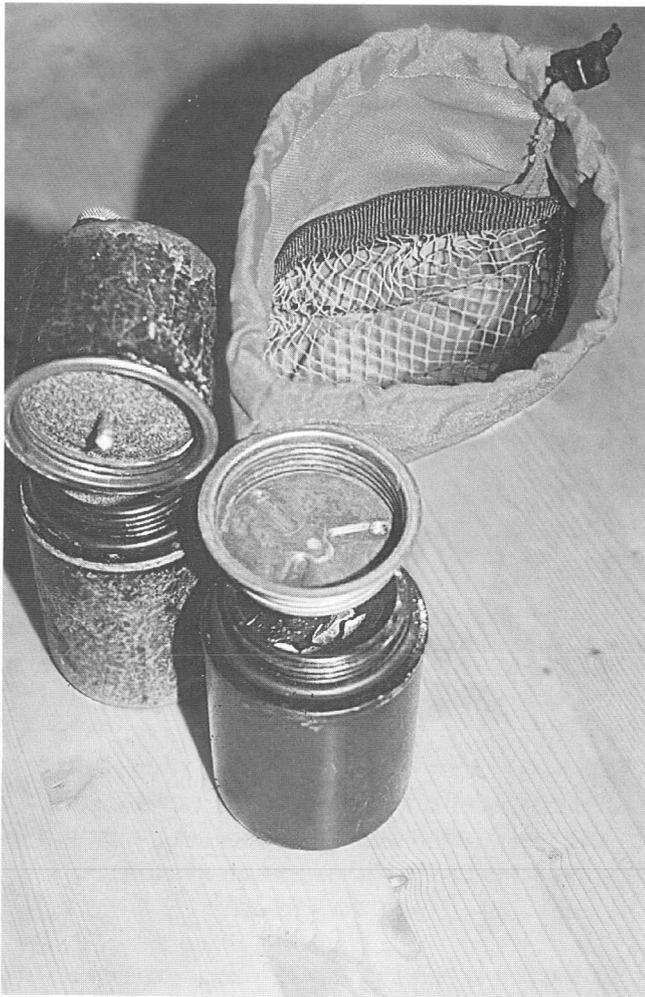
photo 2 : pots avec bouchon pour la recharge de carbure (photo C. Lopes).
