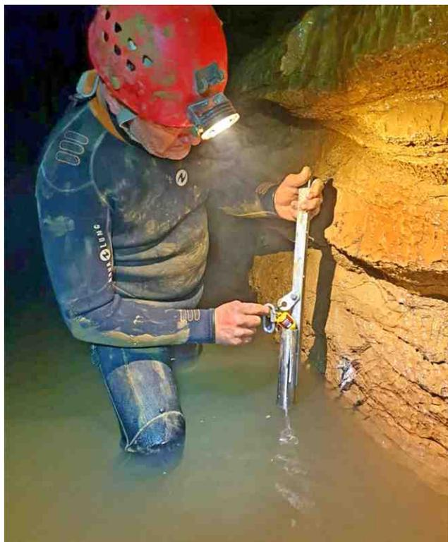
Mise en place dans le Siphon 1 d'une sonde de pression permettant la mesure des débits. (Photo Pascal Reillé)
