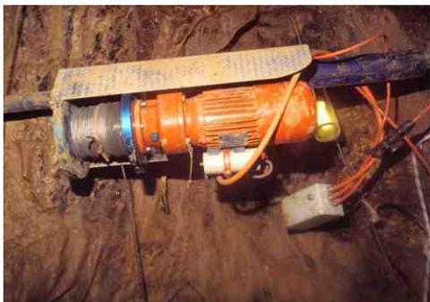
Un treuil est installé afin de tracter les bidons jusqu'à -25 mètres. Le moteur est démonté et ressorti à chaque fois. (Vitesse 16 m/min)
