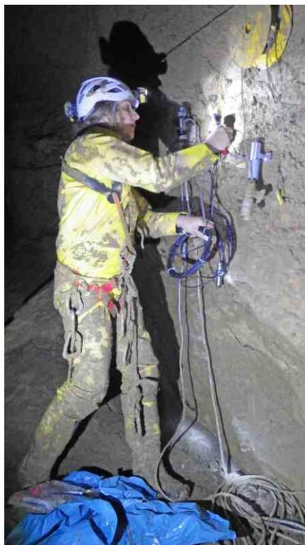
*Installation de la sonde pour le Cave-Link et le détecteur de niveau pour l'alarme par SMS.*
