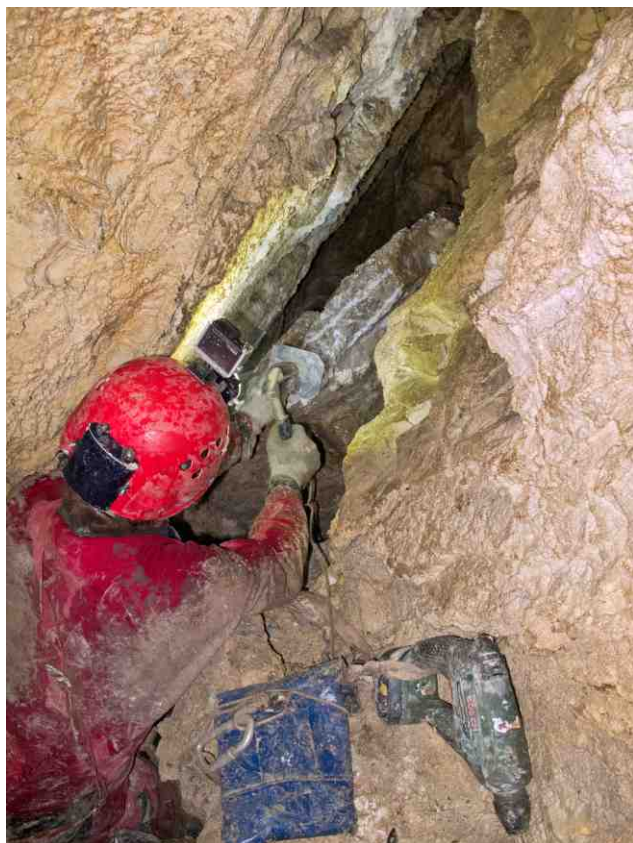
Désobstruction d'une étroiture à l'aide de la technique du Tic-Boum (cartouche Hilti et foreuse légère). Un outil qui devient peu à peu classique dans l'équipement d'exploration (photo Yvan Grossenbacher)
